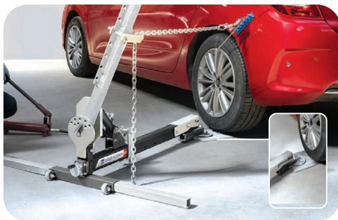
La cale sous roue va permettre le tirage sur les parties arrière du véhicule.
