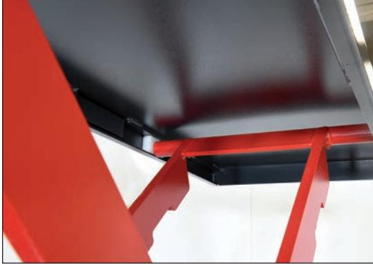
**IT** Pattini di scorrimento inferiore e superiore in materiale plastico autolubrificanti.
