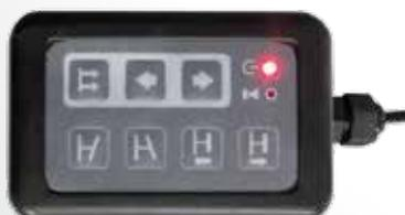
**IT** Regolazione dell'inclinazione del piano tramite telecomando.
