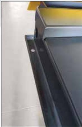
**IT** Sollevatore predisposto con guide per alloggiamento traversa.
