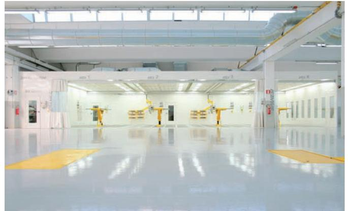
Le soubassement d'une aire de préparation peut être encastré (3 ou 5 rangées de caillebotis), ou posé au sol (5 rangées de caillebotis) avec une hauteur de 330 ou 180mm
