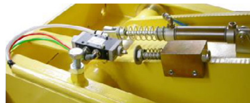
Arrêt de sécurité à la sortie de la fosse, contre le dommage de la partie inférieure du véhicule, et avant d'entrer dans la fosse
