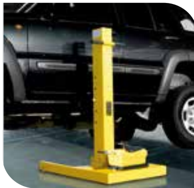
Sollevamento su sottoporta Lifting on the underdoor
