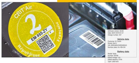
À chaque début de charge, l'utilisateur est invité à scanner différents QR code ou code-barres pour identifier le véhicule et la batterie à des fins de traçabilité. Les informations récupérées sont ainsi stockées dans la mémoire du Gysflash. Ces données apparaissent sur les tickets d'impression et les fichiers de traçabilité sont exportables sur clé USB.
