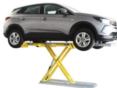
Levage par la sous caisse avec les tampons
