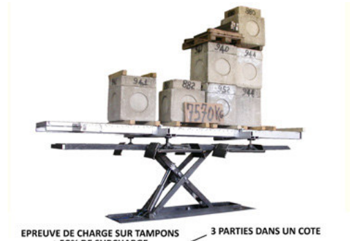
EPREUVE DE CHARGE SUR TAMPONS + 50% DE SURCHARGE NORMATIVE EUROPEENNE EN 1493 3 PARTIES DANS UN COTE 1 PARTIE DANS LE COTE OPPOSE
