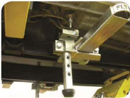
Systeme de fixation sur trous renforcés
