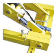
Arrêt de sécurité en descente Signal sonore en descente
