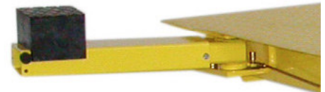
Les bras de levage télescopiques restent à l'intérieur de l'encombrement du véhicule soulevé, pour la sécurité des personnes travaillant à proximité du véhicule
