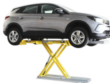
Levage par la sous caisse avec les tampons
