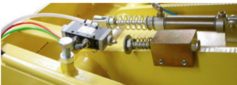
Arrêt de sécurité à la sortie de la fosse, contre le dommage de la partie inférieure du véhicule
